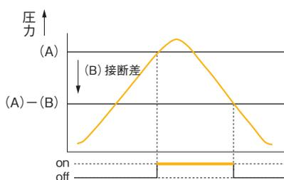
設定点Aの設定値を(A)、接断差を(B)とした時の、コンパレータ動作を示しています。
