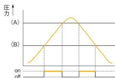
設定点Aの設定値を(A)、設定点Bの設定値を(B)とした時の、コンパレータ動作を示しています。
